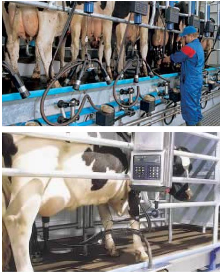
Figura 73: Postazione fissa di mungitura con addetto all'opera (sopra). Bovina con mungitrice in funzione (sotto).
