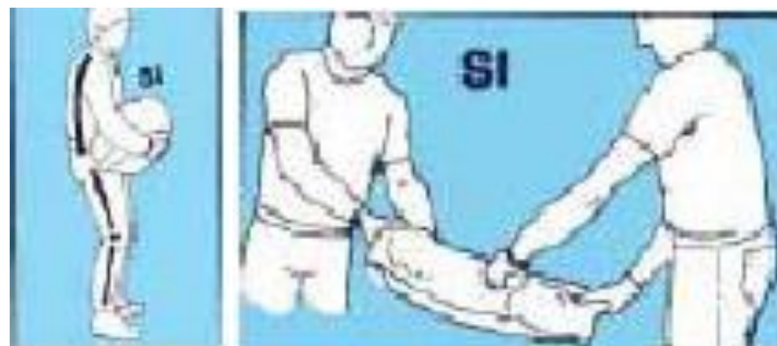
Figura 49: Procedura per il corretto sollevamento dei sacchi di mangime.
